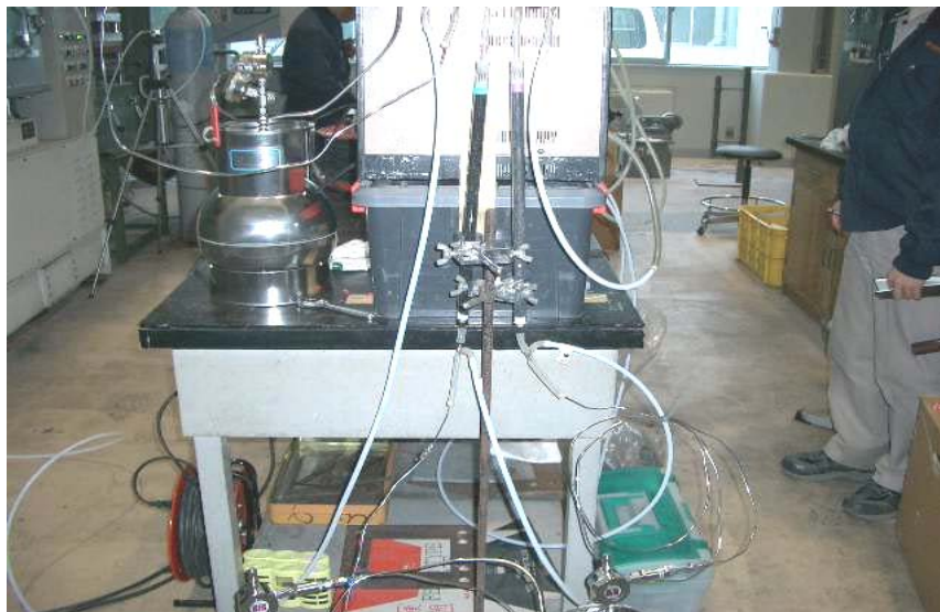
④活性炭カラムの設置状況
